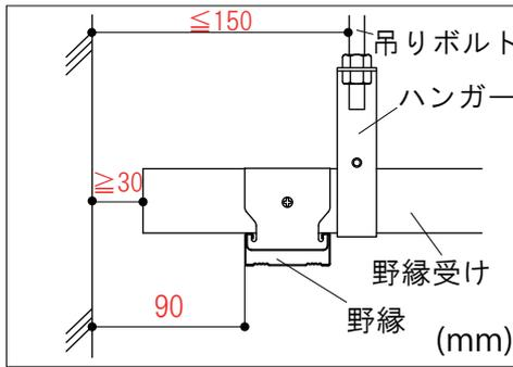
1.天井下地の各部材と壁との寸法を確認して下さい。
