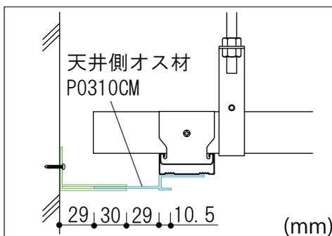
4.天井側オス材を、壁側メス材と組み合わせ、中心に位置を合わせて下さい。
