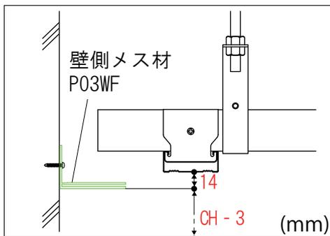
3.壁側メス材の固定位置寸法(上記の位置)を確認し
